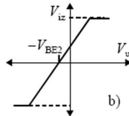
Da bi se ovo otklonilo potrebno je da ulazni napon ima i jednosmernu komponentu  $V_u=V_{BE2}$ .
