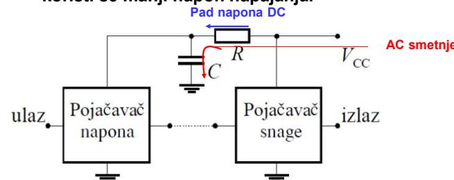
Izvođenje napajanja kod kola koja sadže pojačavače snage u izlaznom stepenu
