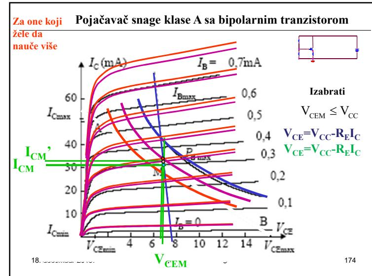
**Za one koji žele da nauče više** Pojačavač snage klase A sa bipolarnim tranzistorom
