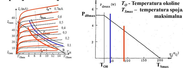
$$\text{Za } T_o > T_{O0} \quad T_{Smax} - T_o = R_{th} \cdot P_{dmax}$$
